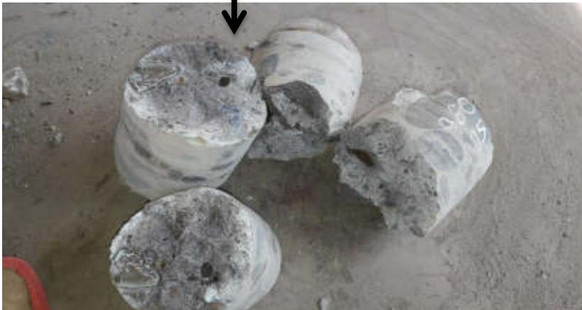
Nota: En profundidad se observaron varias fisuras. No se pudo preparar el testigo para su rotura.
