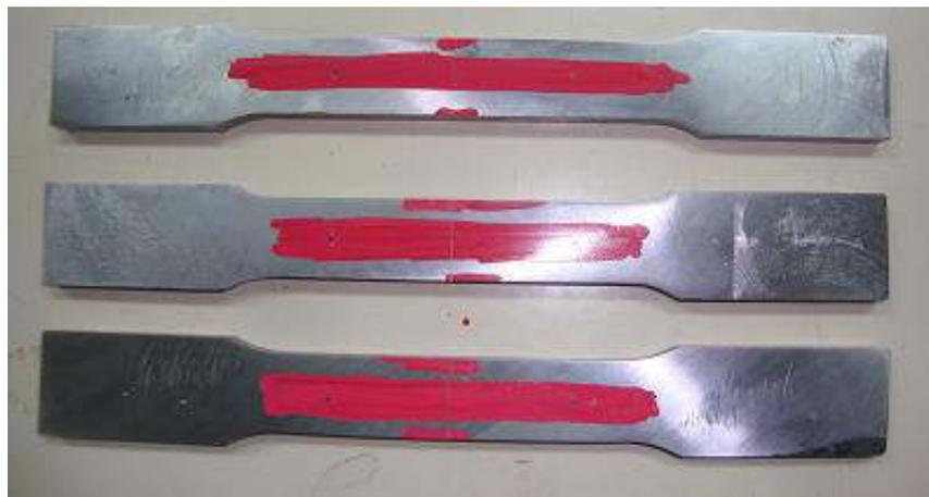
Fotografía N°4: Probetas antes del ensayo
