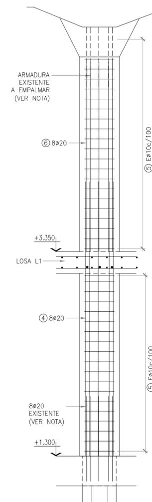
NOTA: EMPALME MEDIANTE SOLDADURA.
